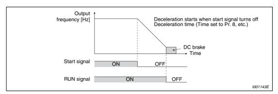
Fig. 6-41: Stop operation when parameter 250 = 9999
