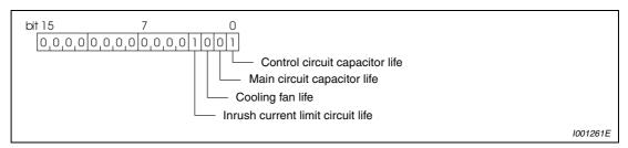
Fig. 6-140: Bits of parameter 255
