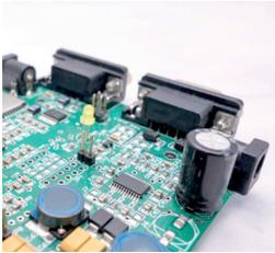
**Elektronische Bauteile** mit Kondensatorschaltungen haben am verzerrten Netz eine deutlich erhöhte Verlustleistung und dadurch eine radikal reduzierte Lebenserwartung.
