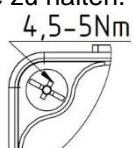
Der Klemmenkastendeckel ist, nach erfolgtem elektrischen Anschluss, mit den Schrauben mit einem Anzugsmoment von 4,5-5Nm zu verschrauben.
