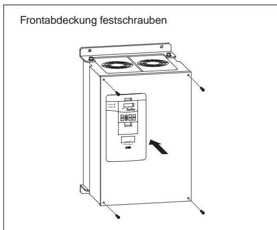
Abb. 1-6: Anbringen der Befestigungsschrauben an der Frontabdeckung
